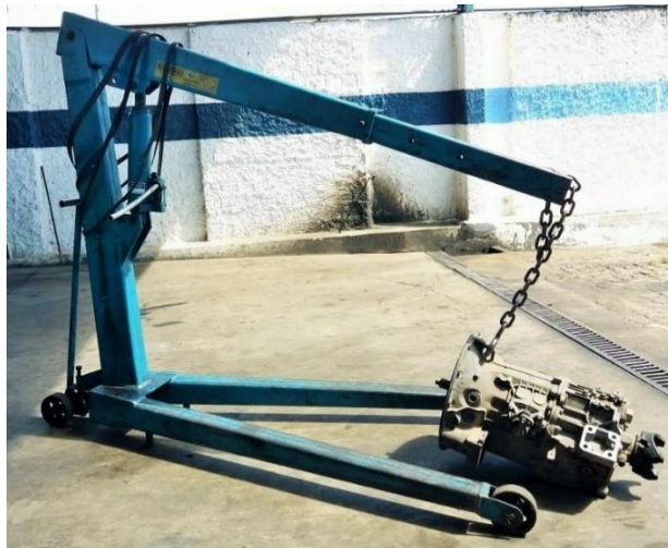
Figura 10. Guincho hidráulico utilizado para o levantamento das peças e equipamentos
