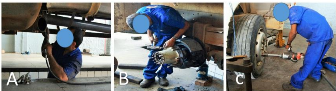
Figura 12. A) Trabalhador realizando conserto na parte inferior do caminhão; B) funcionário instalando o sistema de freio; C) mecânico colocando as rodas do veículo.
