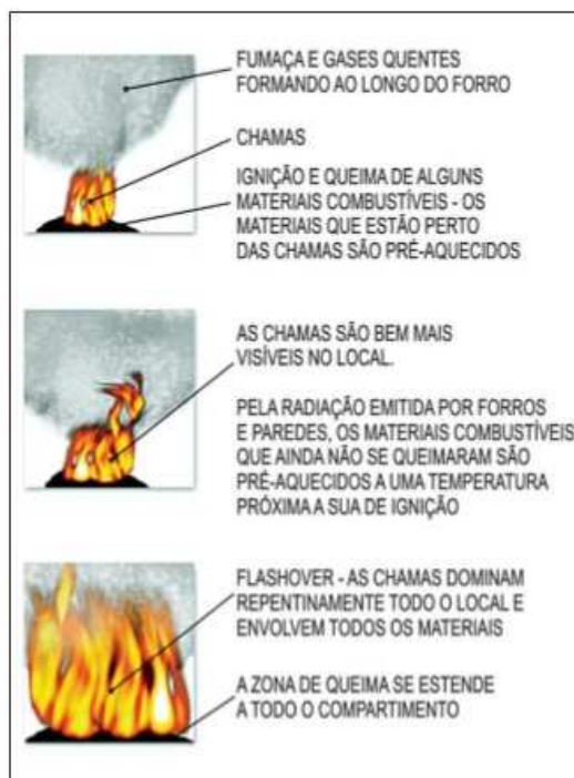
Figura 6: Evolução da propagação da chama nos materiais combustíveis. Fonte: CBMRN, 2018
