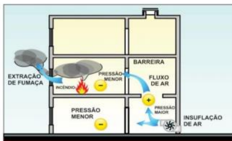
Figura 4: Controle de fumaça através do diferencial de pressão Fonte: IT 15/2018-CBMRN. p. 3.
